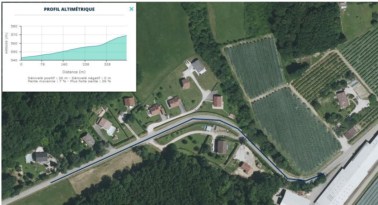
Illustration 327 : Contrainte 8 : rampe de 8 % sur 300 m. Coordonnées 46.023511, 6.038489.
